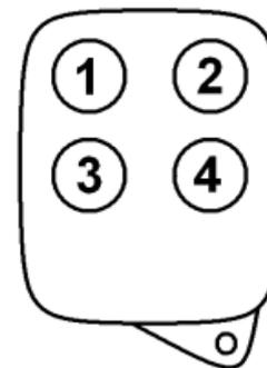
**Пример 2:** двойное нажатие кнопки 3 ручного передатчика СН4Н с присвоенным выходом 4 приёмника, выбранным на шаге 2 выше, запрограммирует первые три кнопки на приёмник. Теперь кнопка 3 управляет выходом 4, кнопка 2 – выходом 3, а кнопка 1 – выходом 2. Кнопка 4 этого передатчика не будет активна для данного приёмника.
